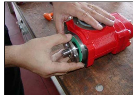
La fase di sostituzione della boccola viene rimpiazzata dall'introduzione dello "Speedi sleeve".
